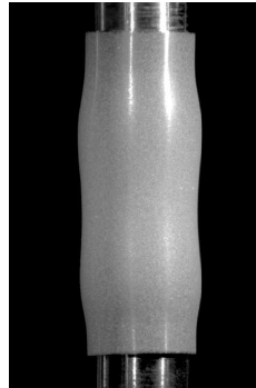
Figure D.17 – Epreuve de 30\text{ mm} de long en Zircaloy-4 non hydruré au cours d'un essai EDC réalisé à température ambiante à l'aide d'une pastille en aluminium (vitesse de déplacement de 1.5\text{ mm.s}^{-1} ).
