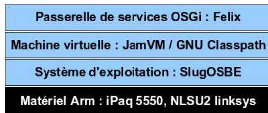
FIG. 2.6 – Pile d'exécution embarquée pour OSGi
