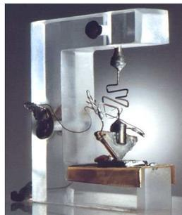
Figure 1-3 : Premier transistor réalisé en 1947 aux Laboratoires Bell
