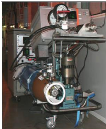
FIG. 2.3 – Photographie du compresseur surmonté du dispositif de régulation de la pression. Une bouteille d’hélium est accrochée à la structure métallique qui supporte le tout.
