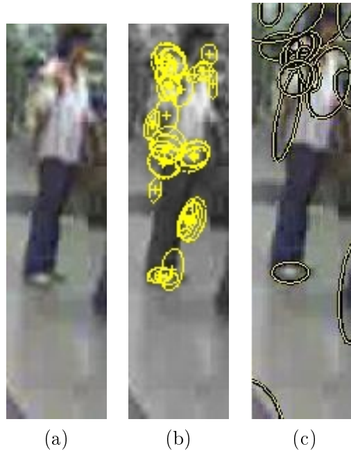
FIG. 4.8 – (a) blob d'une personne détectée ; (b) points d'intérêt de Harris Affine ; (c) points d'intérêt de MSER.
