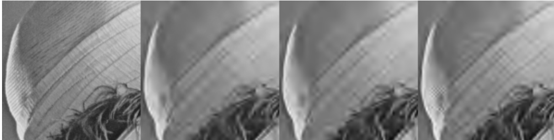
FIG. 4.15: Zoom sur le chapeau de Lena pour un TC = 64 : 1 (0,0125 bit/pixel), images de gauche à droite : originale, SPIHT, JPEG2000, QVAZM.
