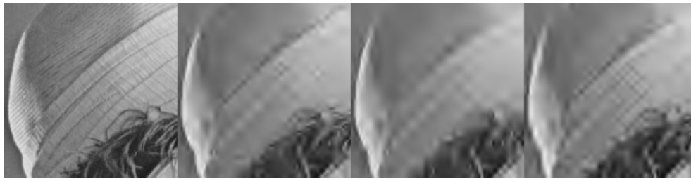
FIG. 4.14: Zoom sur le chapeau de Lena pour un TC = 103 : 1 (0,0777 bit/pixel), images de gauche à droite : originale, SPIHT, JPEG2000, QVAZM.
