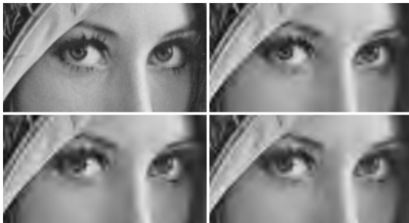
FIG. 4.16: Zoom sur les yeux de Lena pour un TC = 64 : 1 (0,125 bit/pixel), images du haut : originale, QVAZM, images du bas : JPEG2000, SPIHT.
