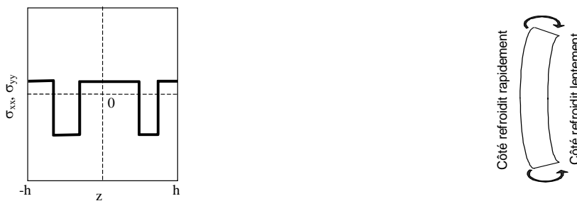
Figure 1.16: Profil de contrainte en refroidissement dissymétrique : pour z = -h , le coefficient de transfert thermique est plus grand que pour z = h
