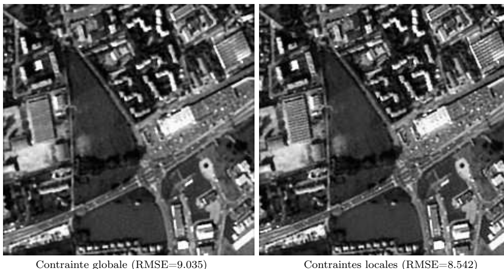
FIG. 7.6 – Restauration de l’image perturbée présentée sur la Figure 7.5 (cas de l’échantillonnage irrégulier) [67]. On obtient effectivement des meilleurs résultats en utilisant des contraintes locales.
