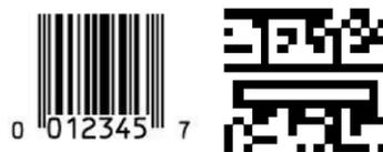
Fig. 1.1 Code à barres une dimension et code matriciel deux dimensions.
