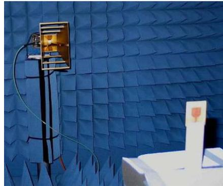
Fig. 3.19 Mesure de diagramme de rayonnement en chambre anéchoïque.
