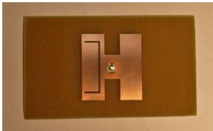
Fig. 3.27 Réalisation de l'antenne patch miniaturisée [3.5].
