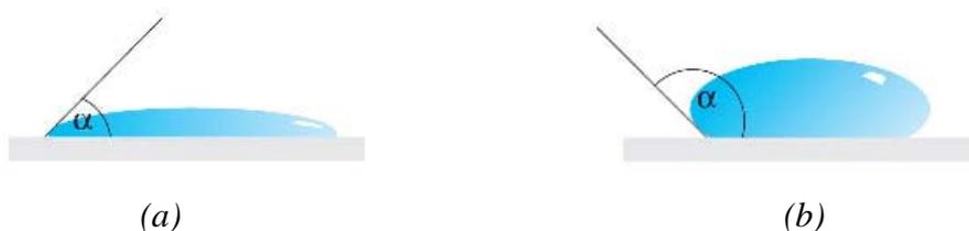
Fig. 6.11 Représentation de l'adhésion de l'encre en fonction de la tension de surface de cette dernière et du support. (a) Tension de surface du support inférieure à celle de l'encre. (b) Tension de surface du support supérieure à celle de l'encre.
