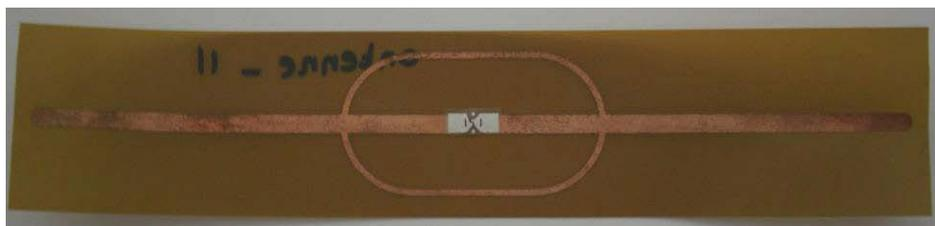
Fig. 4.38 Réalisation de l'antenne dipôle adaptée par courts circuits inductifs.
