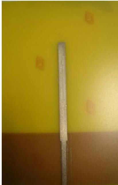
Fig. 6.23 Réalisation de l'antenne monopôle sur substrat FR4 (Propriété Ardeje - LCIS).
