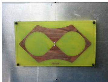
Fig. 3.20 Réalisation de l'antenne Biquad pour lecteur RFID.
