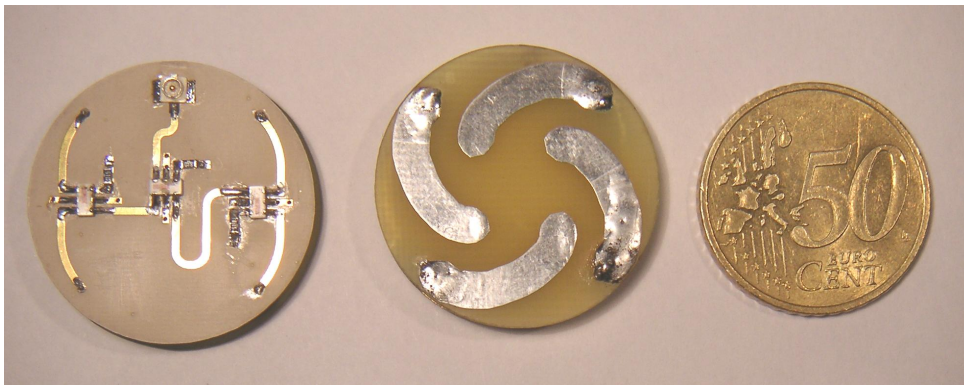
FIG. 4.14.: Photo de l'antenne M51. A gauche, le réseau d'alimentation placé sous la structure. A droite les toits des antennes IFA placés sur le dessus.
