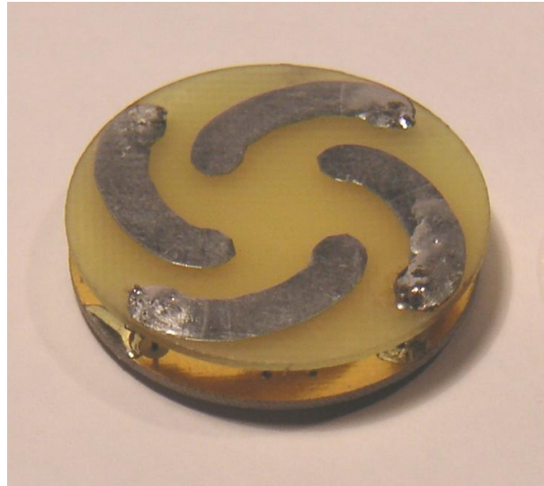
FIG. 4.13.: Antenne M51 : Photo en perspective du prototype.
