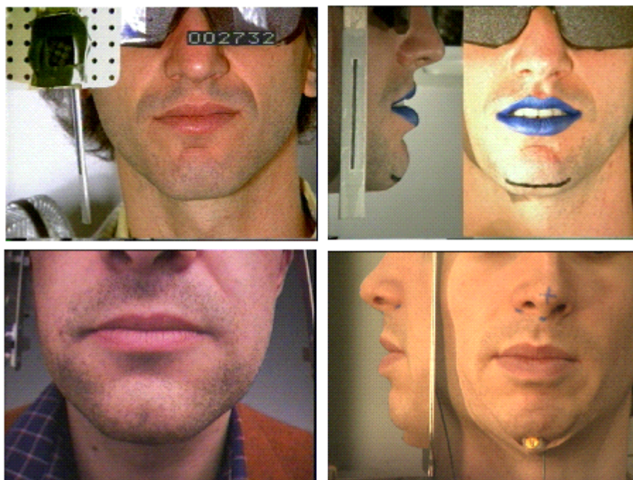
Figure 6. Les enregistrement vidéo : type ICP (en haut), type casque (en bas, à gauche), type ATR (en bas, à droite).
