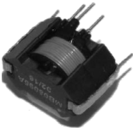
Figure 1-a. Transformateur d'isolation télécoms
