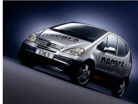
Figure n° I-4: Concept car NECAR5 (2001) utilisant une PAC Ballard (75 kW)
