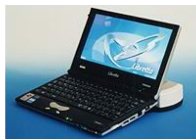
Figure n° I-6 : Pile à combustible au méthanol Toshiba (2004) , autonomie = 20h, poids = 900g
