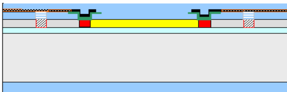
Figure 46 : Dépôt du TEOS sur la face arrière du SOI
