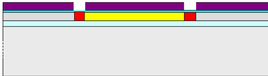
Figure 21 : Deuxième implantation du contact N+
