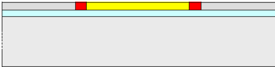
Figure 23: Désoxydation et nettoyage de la face avant
