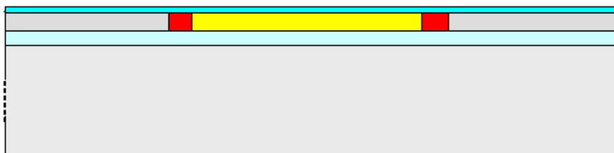
Figure 22 : Recuit d'activation des contacts N+
