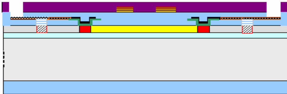
Figure 50: Ouverture des PADs de reprises des contacts
