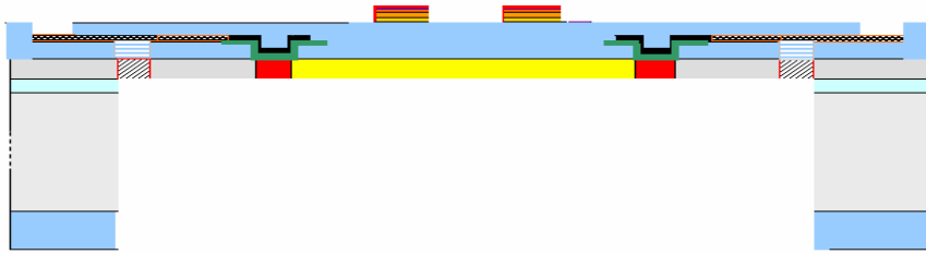
Figure 63 : Retrait de la résine de la face arrière
