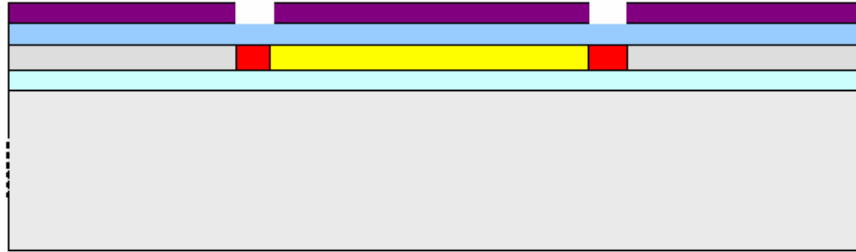
Figure 25: Photolithographie du niveau via
