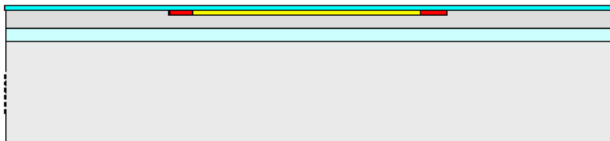
Figure 19 : Dépôt du HTO
