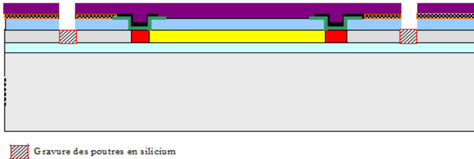
Figure 43: Gravure des structures thermométriques
