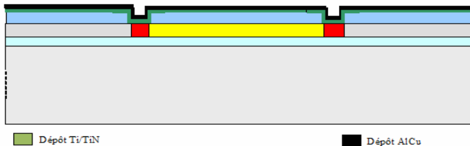
Figure 28 : Dépôt des pistes électriques
