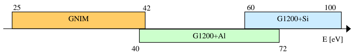
Figure 2.11 : Domaine d'énergie de mesure utilisé en fonction du réseau de diffraction et du filtre
