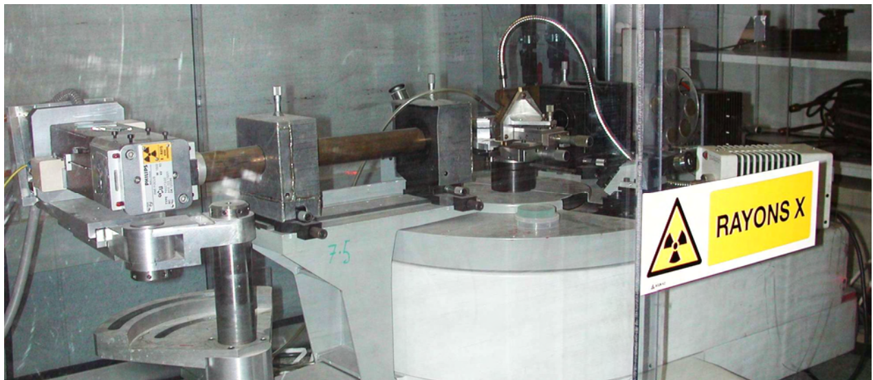
Figure 2.7 : Schéma de principe du réflectomètre X en incidence rasante du LCFIO (GRX1) et photo du système.
