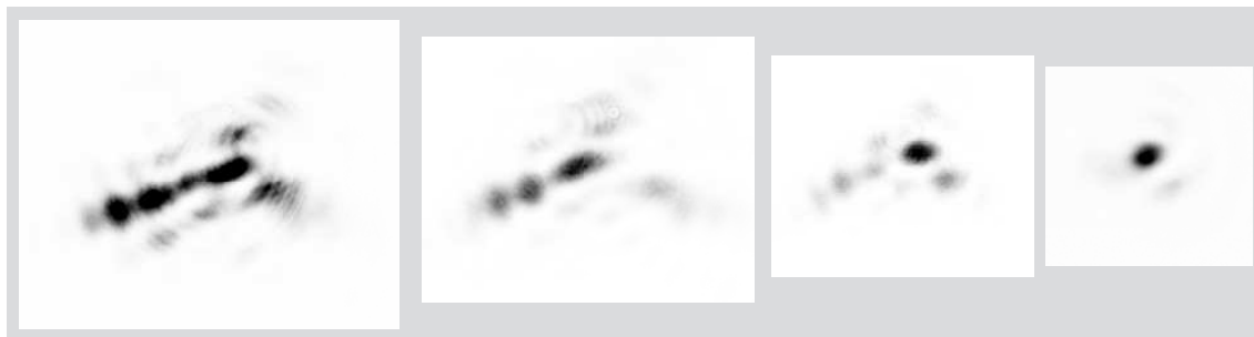
FIG. V.6: Taches focales obtenues au cours de corrections successives.
