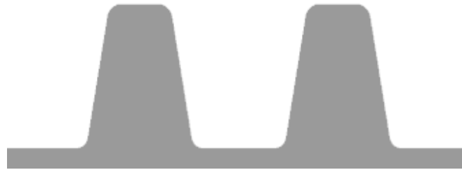
Figure 3.9 Profil d'un réseau de silicium avec parois non verticales et angles arrondis. La période est de 310 nm, la hauteur de 200 nm, l'indice de réfraction du silicium pour la longueur d'onde de 285 nm est pris à 3,5 + i5,5 , l'incidence est normale et la polarisation TM.
