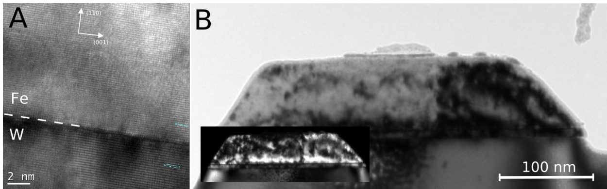
FIG. IV.6: A Relation épitaxiale entre la couche tampon de Tungstène et le Fer. B Champ clair et champ sombre (en insert) du même plot.
