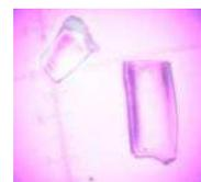
Figure 89 : Observation au microscope optique entre polariseur-analyseur croisés de zircone montrant son isotropie (taille de l'échantillon ~1 mm)
