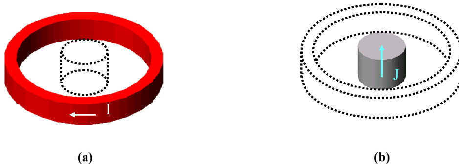
Fig. 4.2 – Essais permettant la détermination des coefficients de couplage : \alpha et \gamma d'une part (a), \beta et \delta d'autre part (b).
