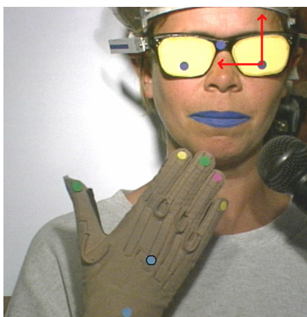
Figure 25. Photo de la locutrice-codeuse portant le gant de données et positions des pastilles de couleur utilisées pour le suivi des mouvements. Le repère référentiel utilisé est tracé en superposition sur la photo.
