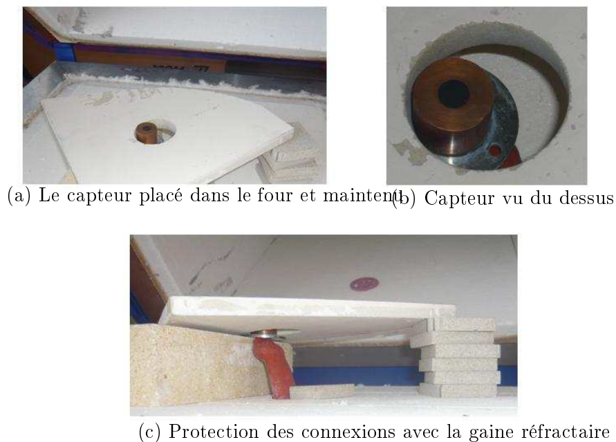
FIGURE 8.9 – Photos du montage de mesure de flux
