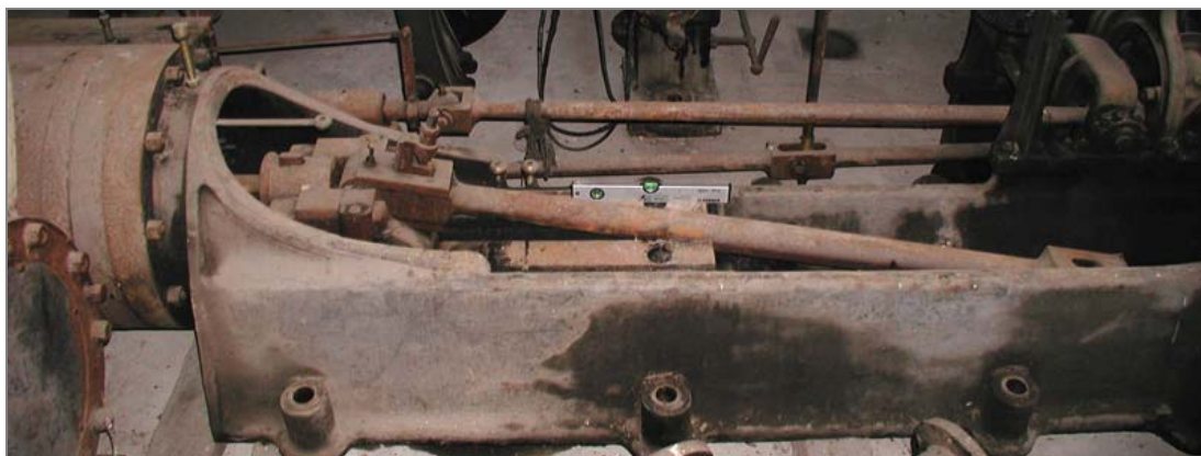
Figure 83 : MACHINE PIGUET N°135 : PARTIE PUISSANCE
