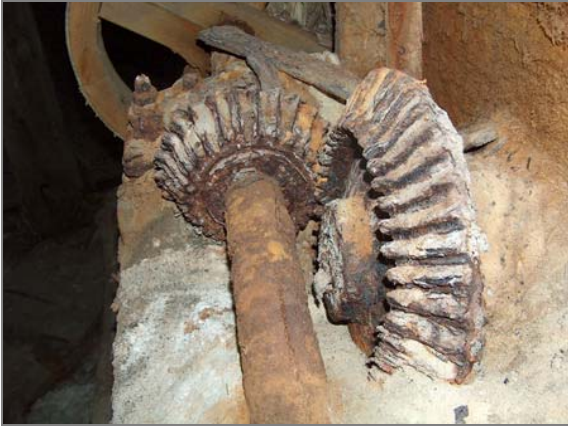
Figure 154 : PHOTO, ENGRENAGES CONIQUES TRANSMETTANT LE MOUVEMENT AU BRASSEUR
