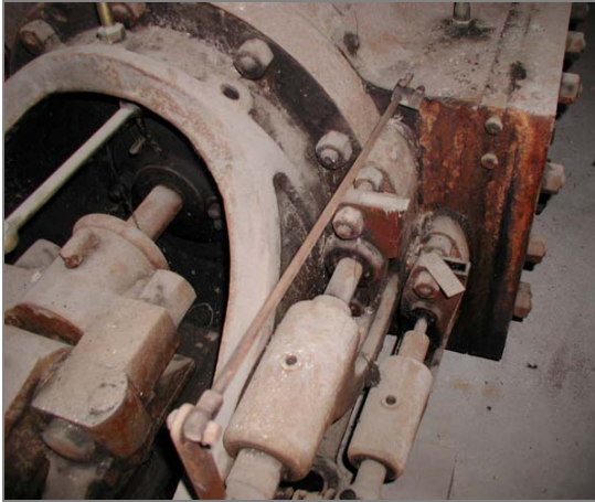
Figure 85 : MACHINE PIGUET : PARTIE COMMANDE DANS LE CYLINDRE
