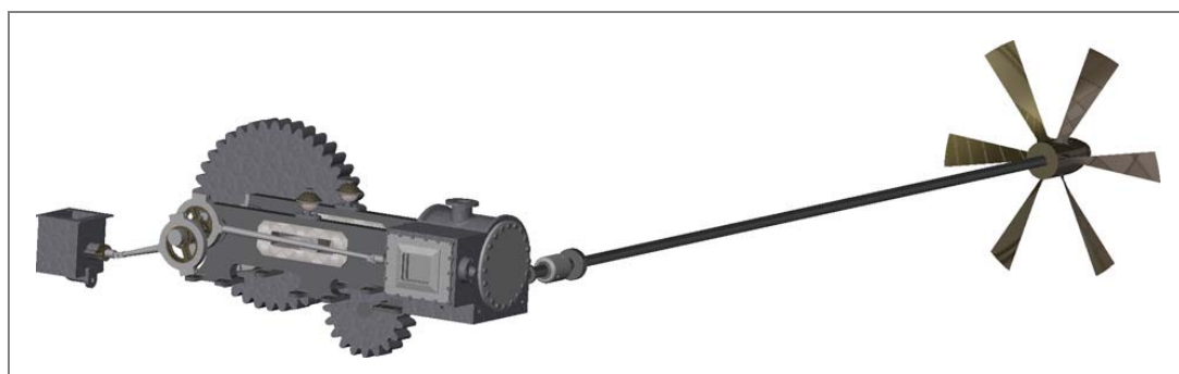
Figure 215 : CANOT A VAPEUR DE 1861, MAQUETTE CAO DE LA TRANSMISSION
