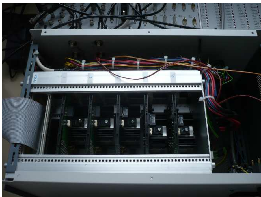
FIG. 4.15 – Convertisseur multiniveaux du CRAN. Chaque plaquette est un niveau du convertisseur.
