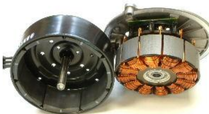
Fig.I-19 Machine synchrone bobinée sur dents.
