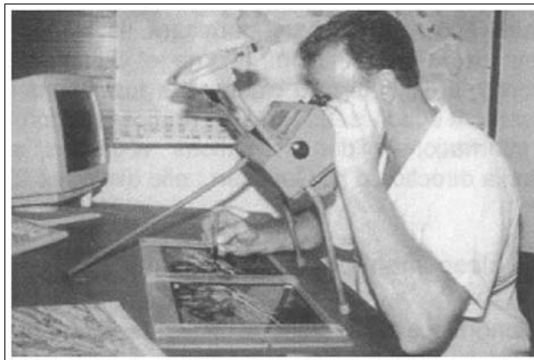
Figure I.6 : Photo-interprétation à l'aide d'un stéréoscope à miroir.
