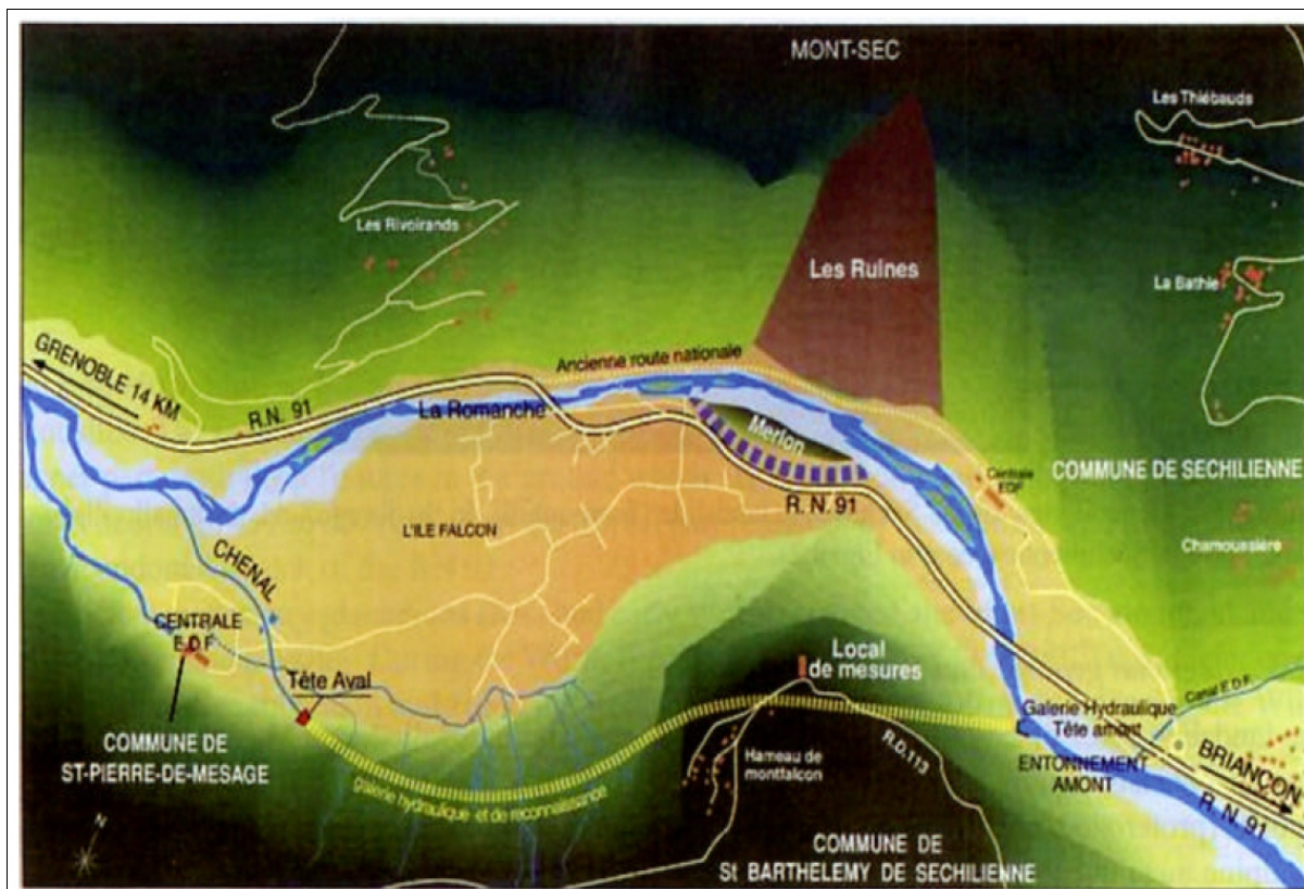
Figure III.2 : Dispositions des différentes actions de conservations mises en oeuvre (déviation, galerie de reconnaissance, local de mesures),
