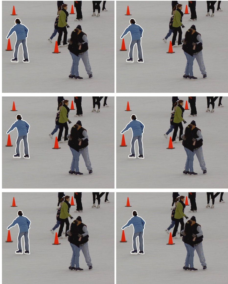
FIGURE 5.17 – Résultat de suivi pour les images I^1 , I^2 , I^3 , I^4 , I^5 , et I^6 (respectivement de gauche à droite et de haut en bas) de la vidéo Ice. La méthode utilise le critère SAD ou pour le critère fondé sur l'entropie du résiduel et un rayon de dilatation de R = 10 . L'erreur est de 4% de pixels mal classés.
