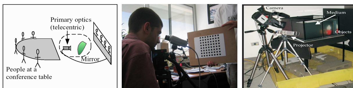
Figure 2.5: Trois scénarios intéressants qui montrent l'importance de modèles de caméra génériques. Gauche : Conception d'un capteur catadioptrique qui produit une image désirée d'une scène d'un certain type [109]. Milieu : Reconstruction de la cornée de l'œil humain en utilisant des images d'une scène réfléchiée dans la cornée [43]. Droite : Caméra regardant au travers d'un médium réfractant [68].
