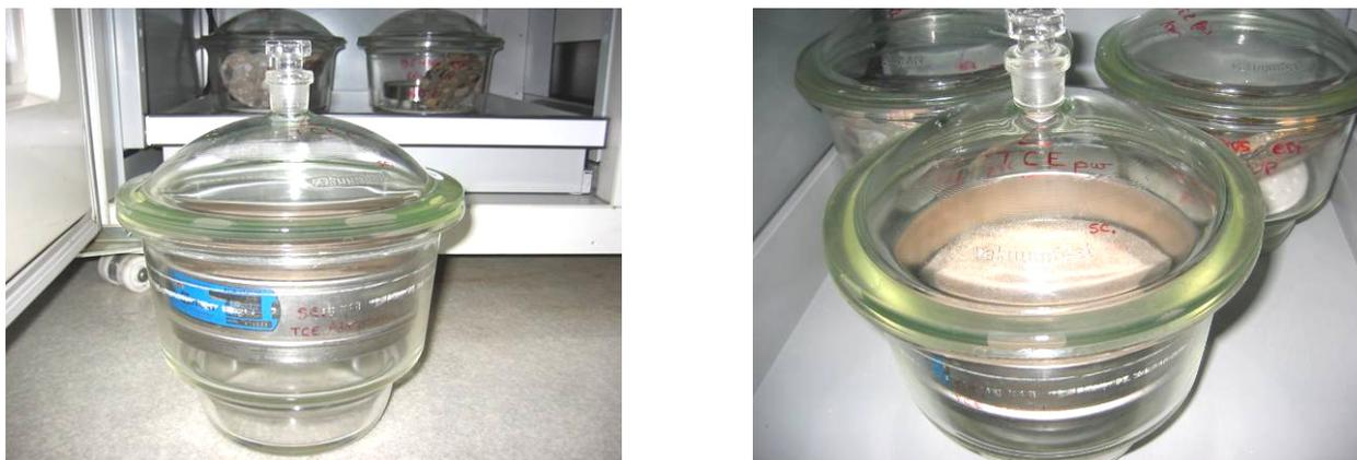
Figure 98 - Dispositif expérimental de mesure de sorption du TCE<sub>a</sub> sur le sable
