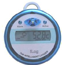
Figure 41 - Thermo-hygromètre
