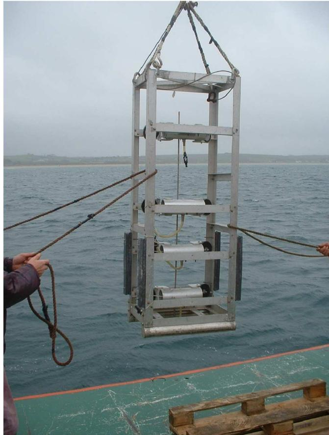
Figure 3.9 – EChantillonneur MULTiple (ECMUL) lors de son immersion.
