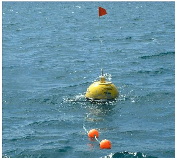
Figure 3.3 – Bouée houlographique DATAWELL Waverider de 0,9 m de diamètre, équipée d'une antenne HF pour la transmission des données en temps réel.
