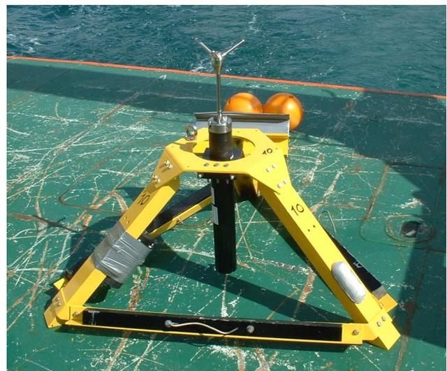
Figure 3.5 – Courantomètre-houlographe VECTOR (NORTEK).
