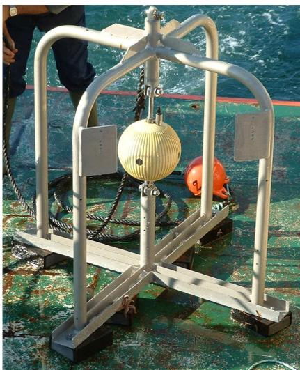
Figure 3.4 – Courantomètre-houlographe S4DW.
