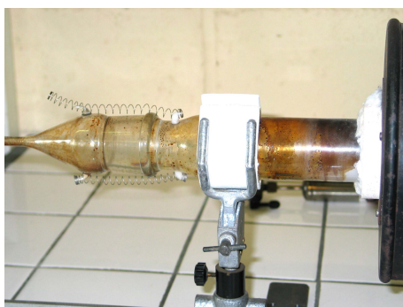
FIG. 3.12 – Dépôt de goudron à l'intérieur du réacteur en quartz.
