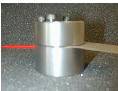
FIG. 2.13 – Photographie du porte-échantillon et de la sonde utilisés pour les mesures de conductivités thermiques.
