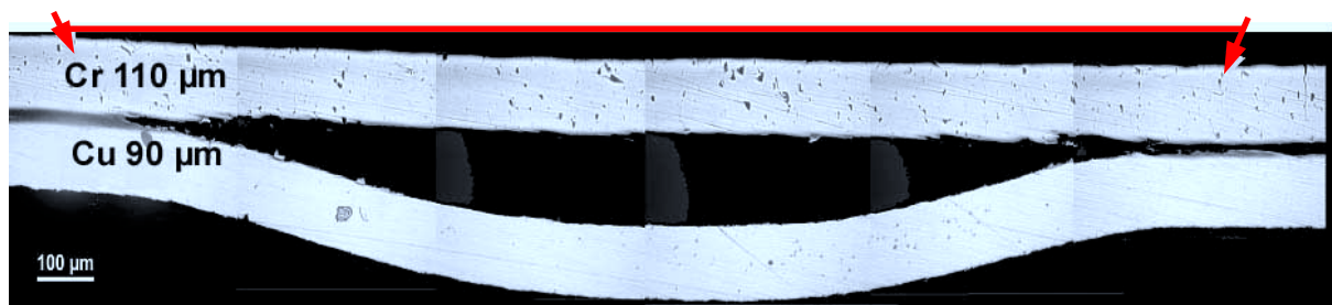
Figure 6.15 : Vue en coupe de l'échantillon LALP0602 crcu2-2s25. Le tir est porté côté chrome. Diamètre de la tache focale de 2 mm, matérialisée par un trait rouge. Flux incident 81 \text{ GW/cm}^2 . La fracture est quasi adhésive.
