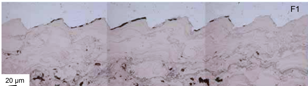
Figure 5.13 : Micrographie d'un échantillons Al 470 µm Cu 300 µm de type F1 éprouvé à 323 GW/cm 2 .
