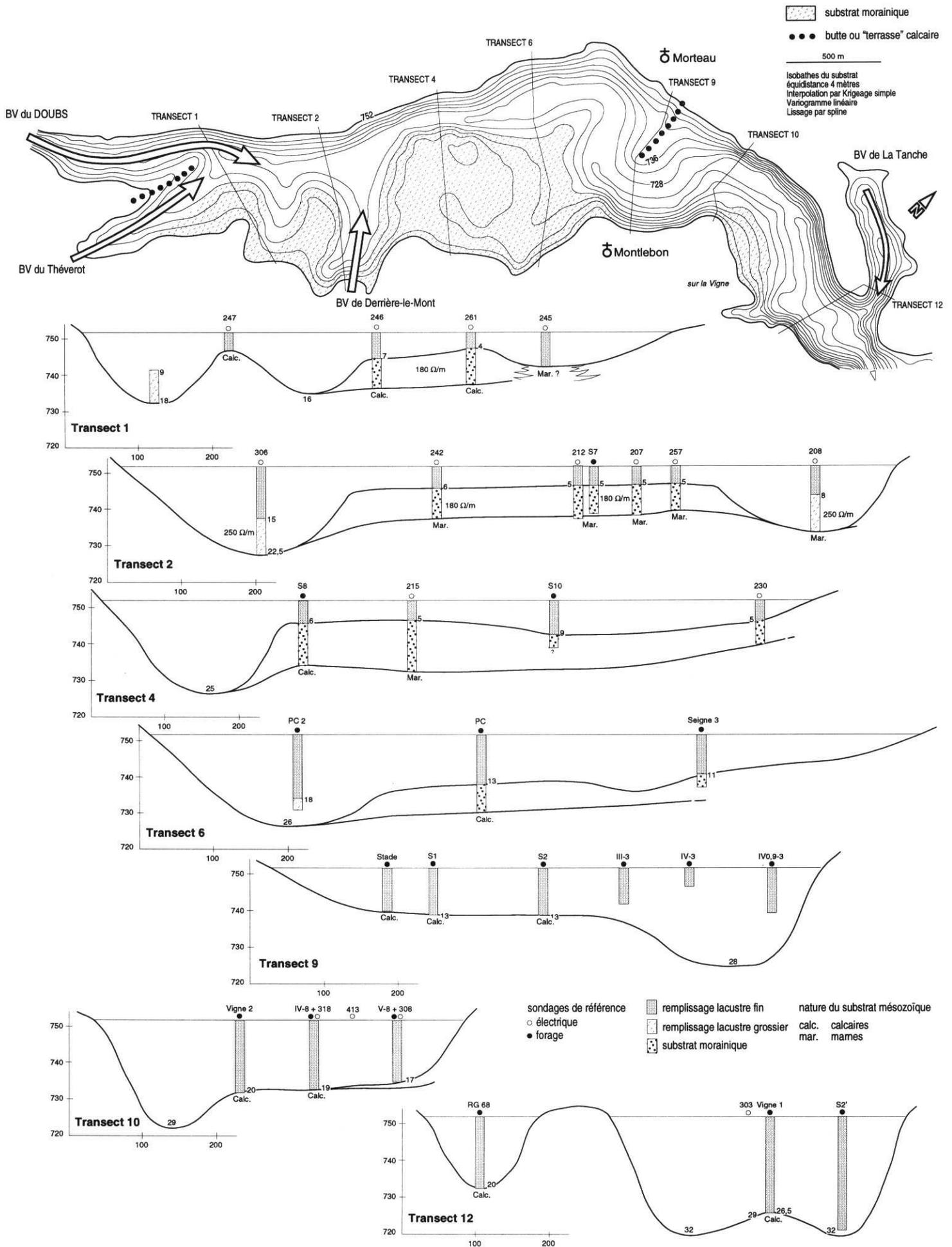
Fig. 76a Topographie de la vallée anté-lacustre d'après les données de forage et la géophysique (zone amont)
