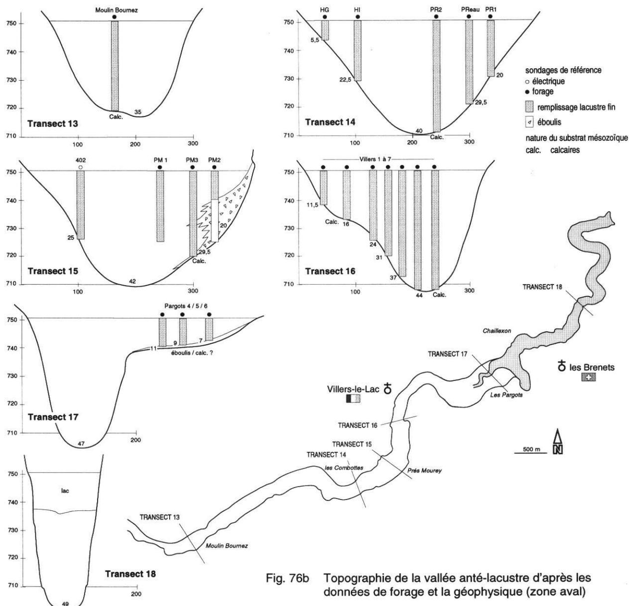
Fig. 76b Topographie de la vallée anté-lacustre d'après les données de forage et la géophysique (zone aval)
