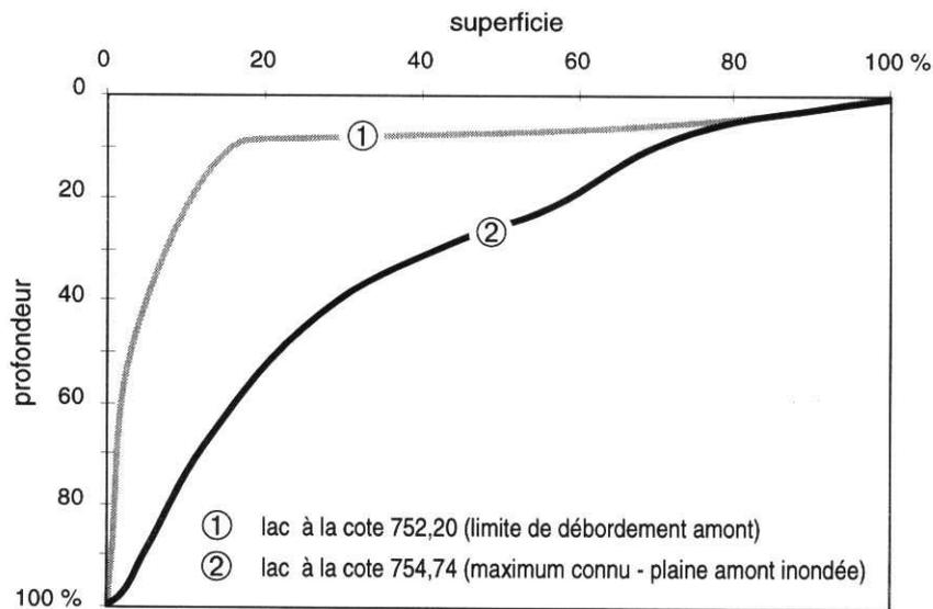
Fig. 33 Courbes hypsométriques du lac en crue
