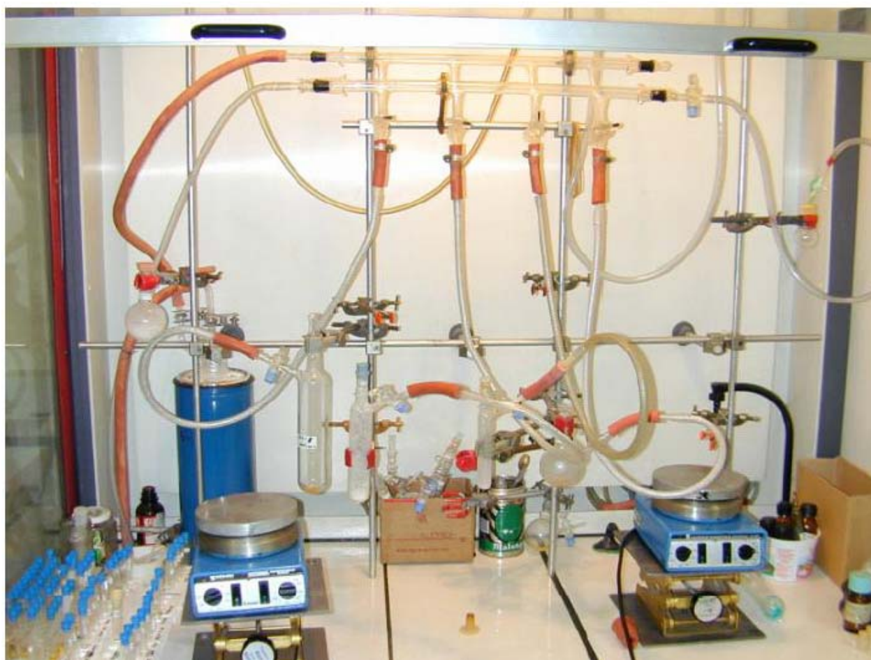
Figure 1 : Rampe à vide et verrerie pour le travail sous atmosphère inerte
