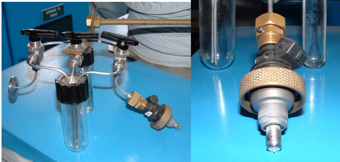
Figure 6 : Photo du système d'injection avec le réservoir à gauche et l'injecteur à droite
