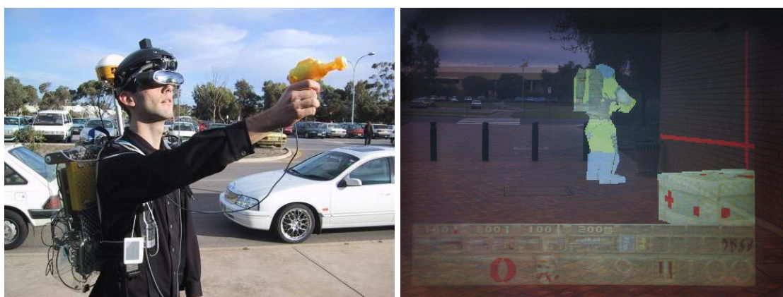
FIG. 1.4 – Vue du système de réalité augmentée ARQuake [Thomas 02] et vue de l'utilisateur.
