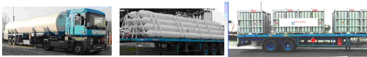
Figure 8 : Camion cryogénique / Camion d'hydrogène gazeux vrac / Camion de bouteilles haute pression
