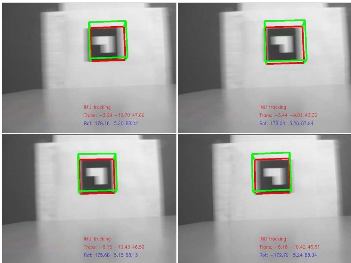
FIG. 4.26 – Résultats de suivi et de recalage avec le capteur hybride en présence de flou de mouvement.
