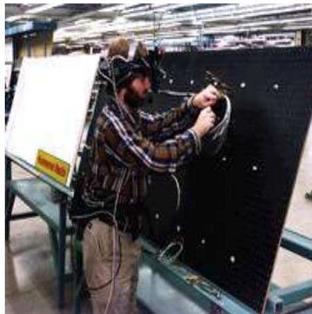
FIG. 1.7 – Application de câblage d'un système électrique dans un prototype de Boeing [25] [76] [143].
