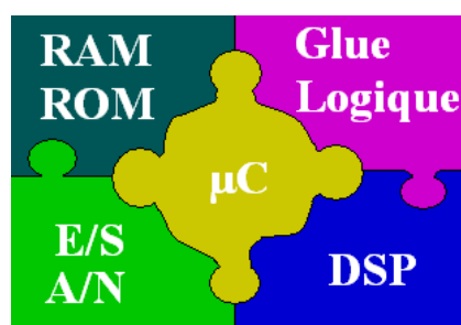
Figure 4-1 : Principe d'un système monopuce typique.
