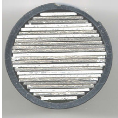
Figure 3.23 : Cylindre actif (gadolinium en plaques)
