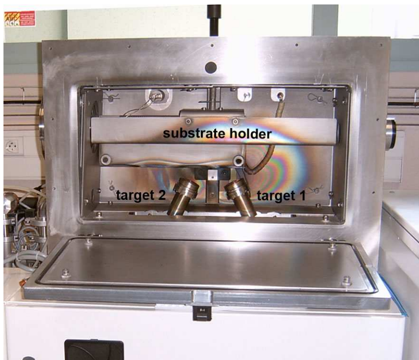
Fig. IV.2 – Photographie de l'appareil de co-pulvérisation HEF utilisé pour le dépôt des couches minces dopées.
