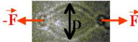
Figure. 2.6 : Un globule avec deux billes en position diamétralement opposée est déformé en augmentant la distance entre les pièges. La variation \Delta D est mesurée en fonction de la force F [LENORMAND2001].
