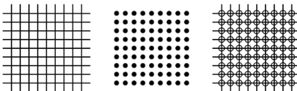
Figure. 3.1 : Différents motifs de grilles utilisés par les méthodes de suivi de marqueurs. [DOUMALIN2000]
