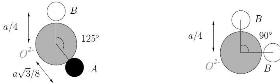
Fig. 2.2 – Couplages de super-échange « antiferromagnétiques » les plus intenses de la structure spinelle.
