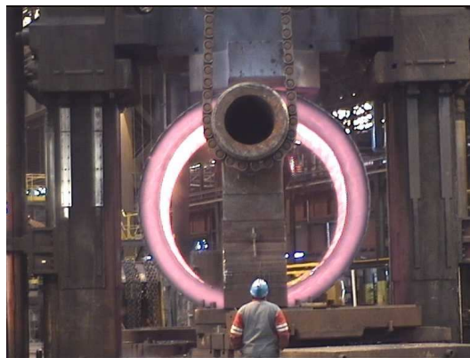
Figure 2.19 – Numérisation d'une pièce de forge à haute température [Bokhabrine et al., 2009]
