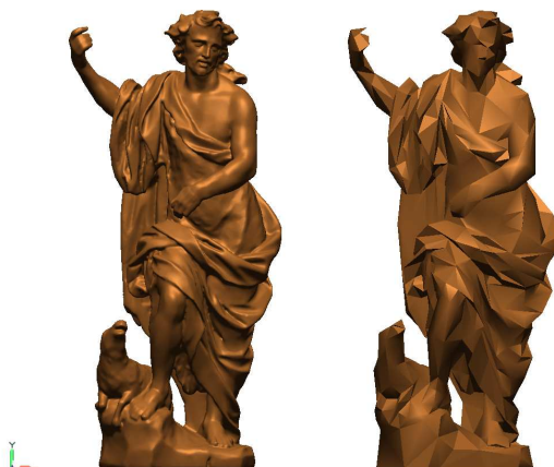
Figure 4.15 – Perte des détails de forme lors de la réduction
