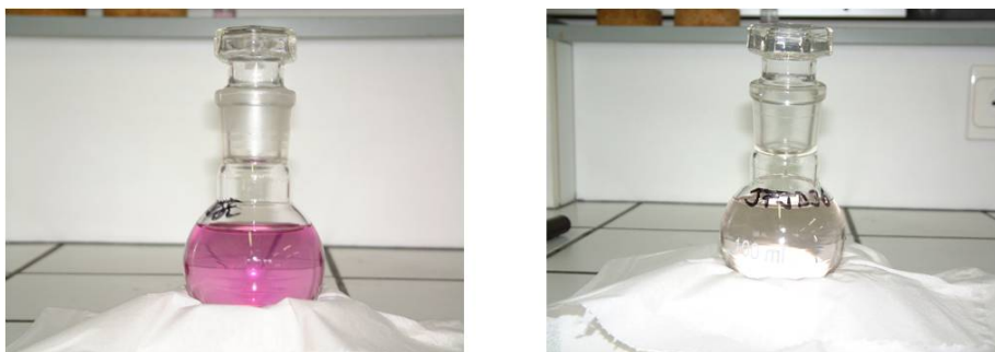
FIG. 6.6: Nanoparticules en solution dans l'état de Bas Spin et dans l'état de Haut Spin
