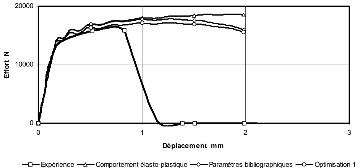
Figure 3.20. Comparaison expérience modèle de simulation - Diagramme effort-déplacement - (1ère optimisation)
