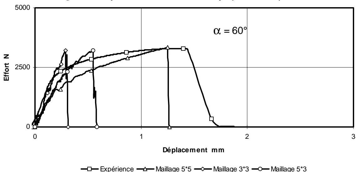
Figure 4.24. Influence de la finesse de maillage des plaques (épaisseur calibrée) - Formulation hybride -
