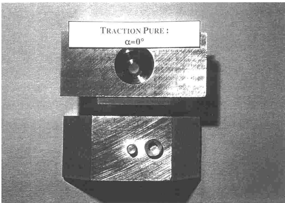
Figure 3.47. Mise en évidence expérimentale du mode de rupture du rivet en traction pure.
