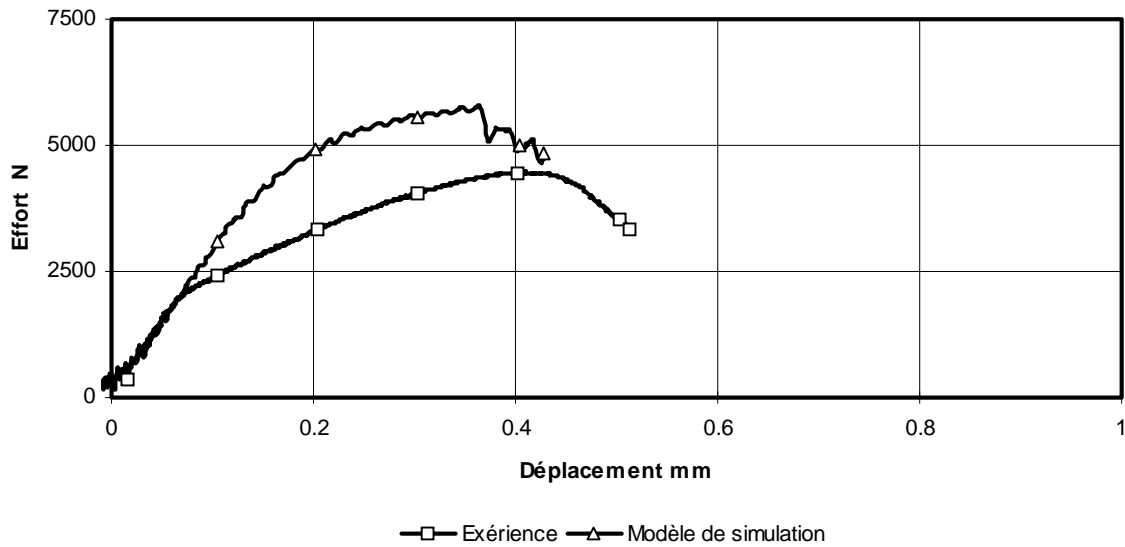
Figure 3.41. Simulation d'une éprouvette ARCAN en traction pure.
