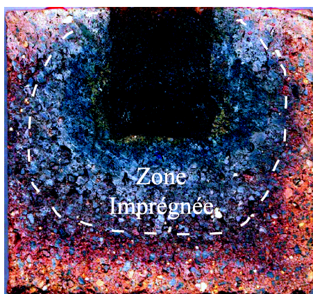
FIG. 2.2 – Demi-creuset après imprégnation (largeur : 110 mm)
