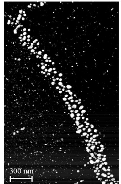
Figure V-17 : Observation au MET d'un 7050 trempé à l'eau froide et sur-revenu.
