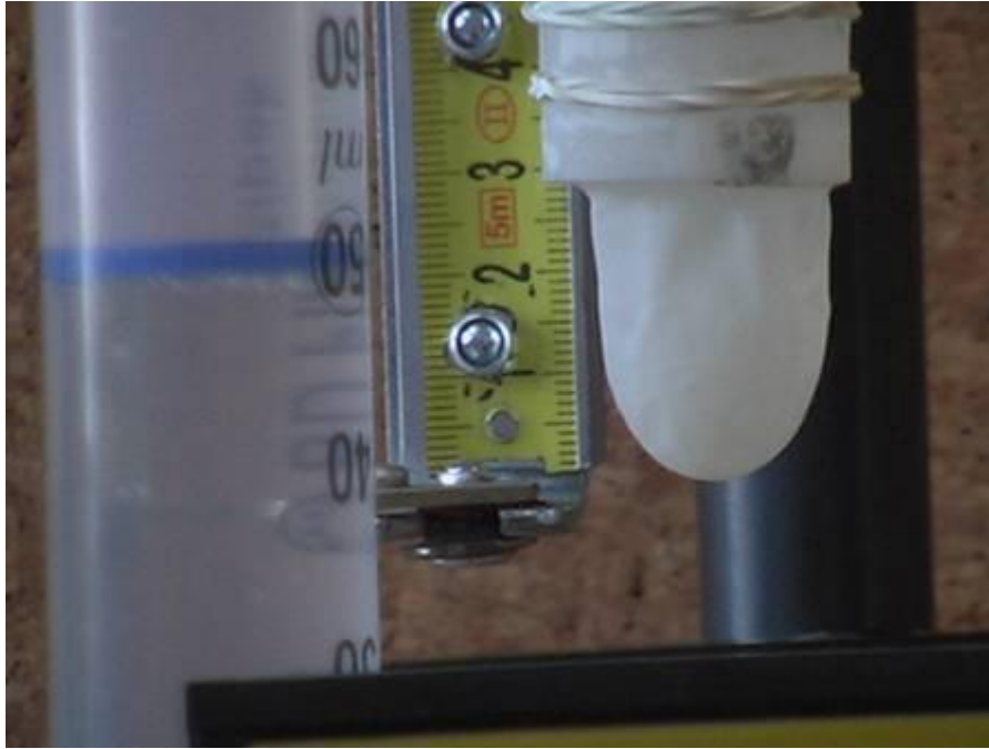
Figure 22 : Gros plan sur la membrane convexe soumise à une hauteur d'eau de 2cm
