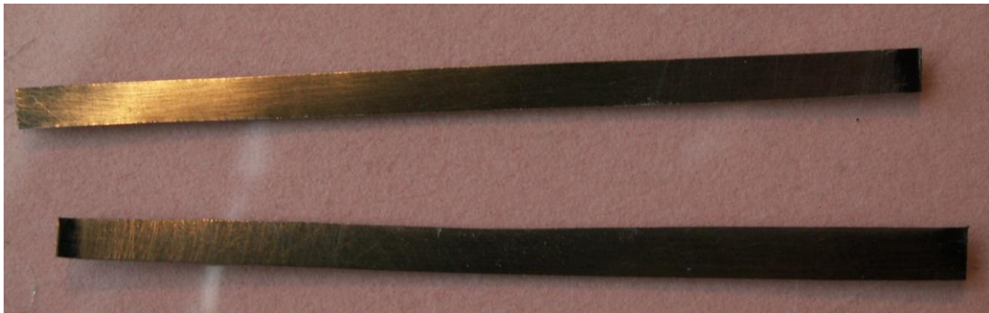
Figure 15 : bandes métalliques de 16/100 d'épaisseur préparées avant le collage des jauges de contrainte. La découpe en fragments de 1cm se fait après le collage des jauges
