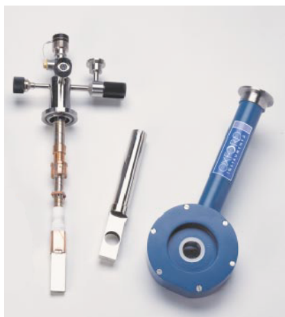
FIGURE 2.7 – Cryostat Oxford : avec de gauche à droite : le doigt froid, le bouclier thermique et enfin l'enceinte du cryostat
