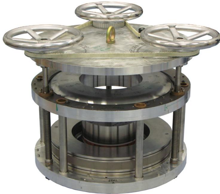
**Figure 4.30:** Machine d'assemblage du circuit magnétique.
