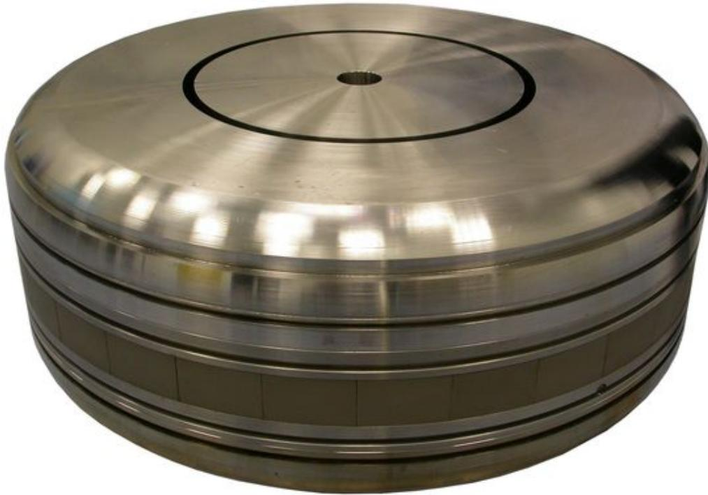
**Figure 4.32:** Circuit magnétique obtenu. Diamètre extérieur 550 mm.
